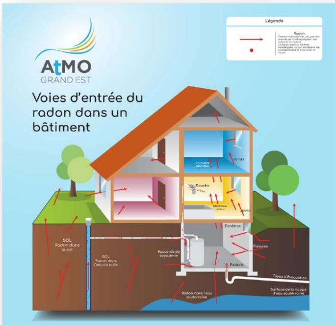
Le radon peut également entrer par un apport d'air extérieur, par dégazage à partir de l'eau sanitaire, ou encore à partir des matériaux de construction.
